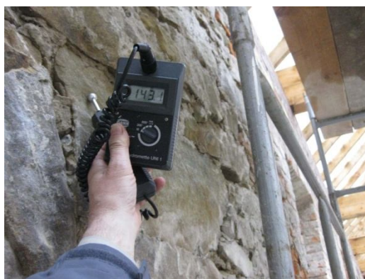
Fot.2 Wysoki wskaźnik wilgoci 2 m powyżej posadzki
